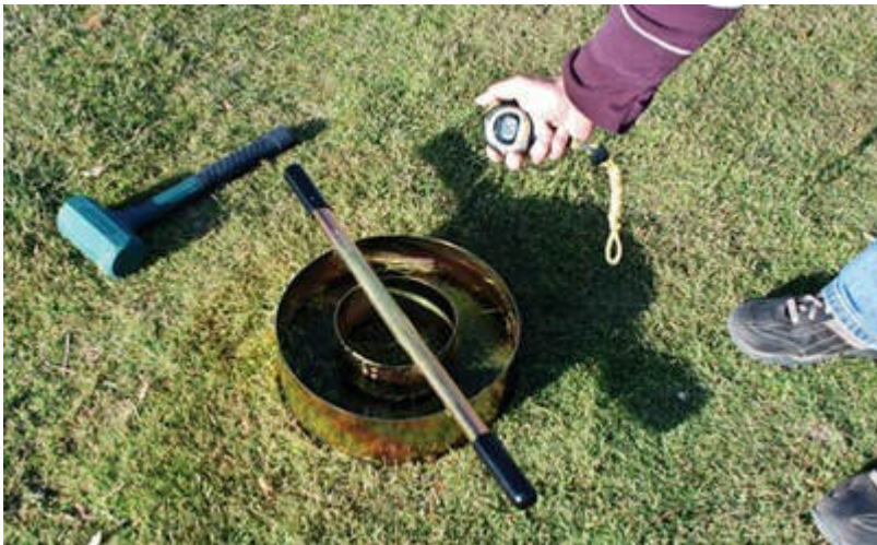
Obrázek 8.8 Provedení infiltrační zkoušky (Zdroj: //americangeoservices.com/soil-infiltration-testing.html , Přístup: 29.09.2023)
