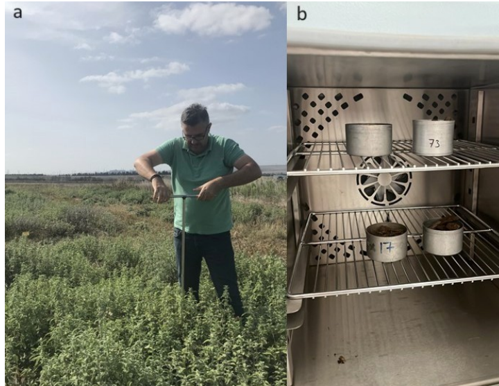
Abbildung 8.3. a) Entnahme der Probe mit einem Schneckenbohrer, b) Trocknen der Probe im Ofen (Foto: Erhan GOCMEN)
