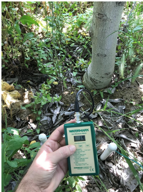
Abbildung 8.5. Elektrische Widerstandsblöcke (Wasserzeichen) (Foto: Erhan GOCMEN)
