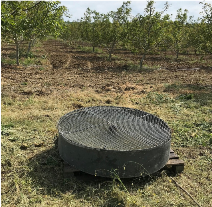
Abbildung 8.9. Verdunstungsbehälter der Klasse A (Foto: Erhan GOCMEN).
