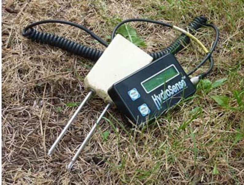
Abbildung 8.6. TDR-Bodenfeuchtemessgerät. (Quelle: Foto von Maja Krzic, Universität von British Columbia, Vancouver BC. Zugriff: https://labmodules.soilweb.ca/time-domain-reflectometry/ 13.10.2023)
