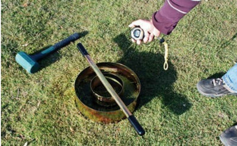
Abbildung 8.8 Durchführung der Versickerungsprüfung (Quelle: https://americangeoservices.com/soil-infiltration-testing.html , Zugriff: 29.09.2023)
